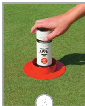
3 噴漆頭置於 噴塗工具中心點， 下壓三至四次 (每次約一秒) 注意：不需要旋轉瓶身
